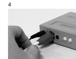
4 Link Cat.5 cable
